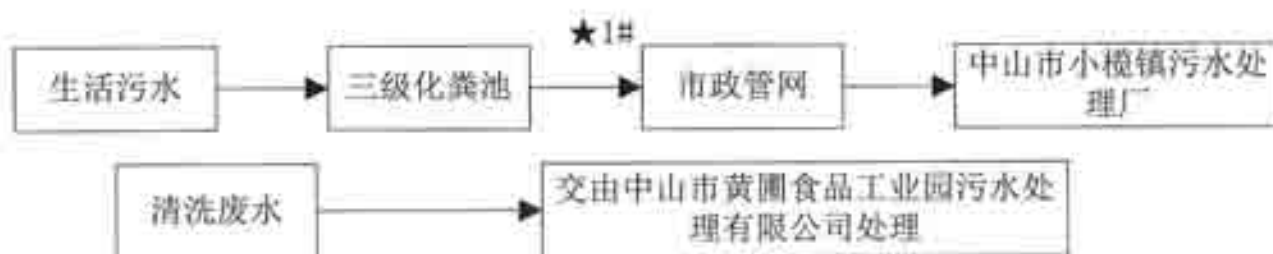
图3-1 废水处理工艺流程图
